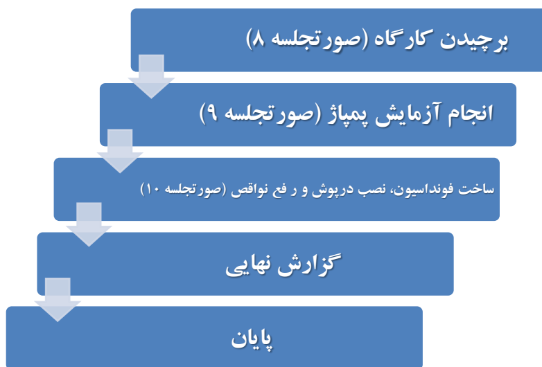
شکل ۴ - مراحل پس از حفاری
